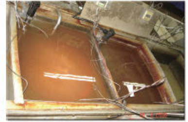
電鍍業漂洗工序需使用大量清水，亦造成大量的污水
