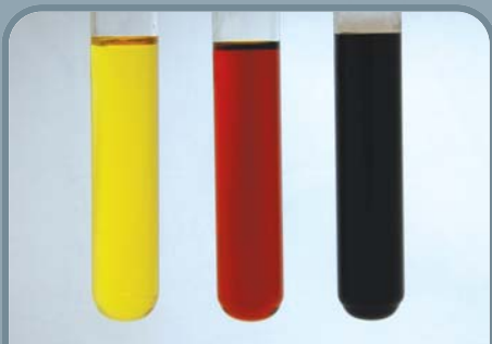
脫色後清油(左)、再生潤滑油/燃油(中)與廢油(右)的比較
